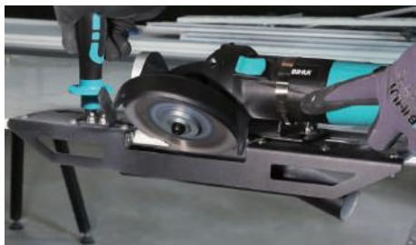
Krok 2. Udržujte ložisko v těsné blízkosti opěrné a posuvné na okraji dlaždice/ obkladu (desky)
