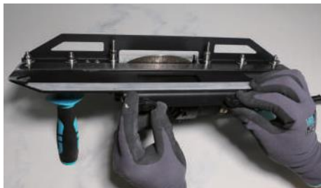
Krok 2. Otáčejte seřizovací šrouby proti směru hodinových ručiček, oba šrouby nechte seřizené. Otáčením ve směru hodinových ručiček získáte tenčí břit proti směru hodinových ručiček získáte silnější řez.
